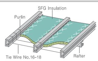
**4. ผึงพุกแล้วจึงลวด หรือ ใช้ Pin & Washer หลังคา Concrete Slab**
