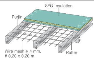
**2. เชื่อมตะแกรงเหล็กใต้แป ปูฉนวนในช่องแป หลังคาไฟเบอร์ซีเมนต์, Metal Sheet**
